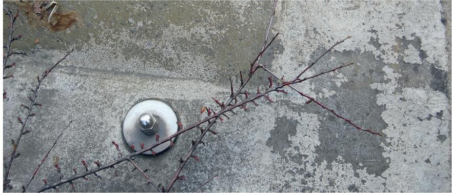
**Bild 1.** Glasfaserverstärkter Kunststoff: durch Außenbewitterung gealtertes GFK mit zerstörter Oberfläche (© werkstoff&struktur)
