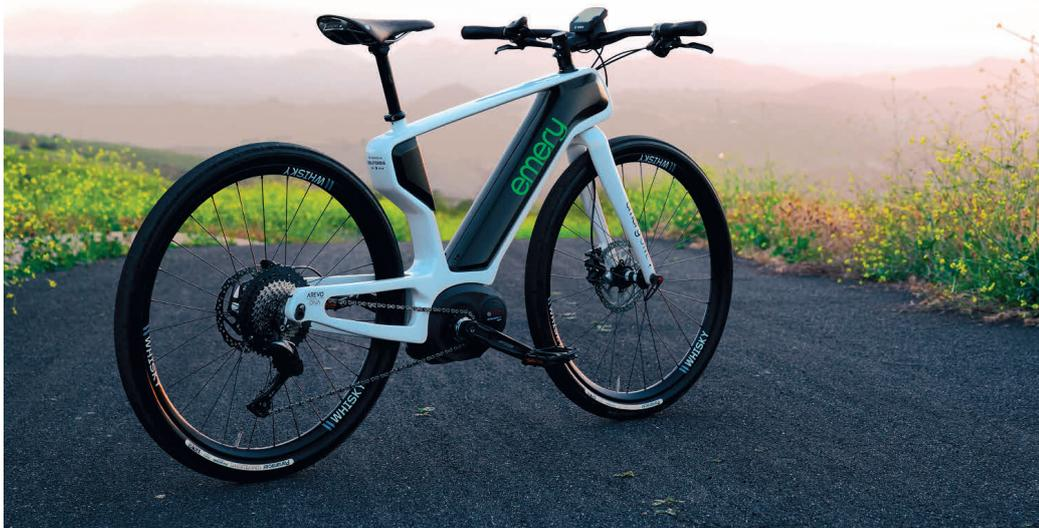
Das Arevo-„ebike“ hat einen 3D-gedruckten CFK-Monocoque-Rahmen, in den u. a. der Drivematic-Getriebe-aktuator von Oechsler integriert werden kann
