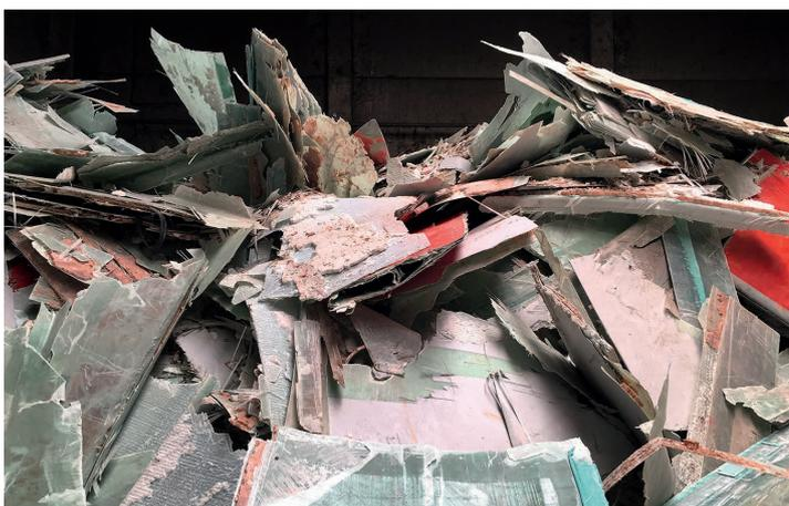
**Bild 5.** Demontierte Rotorblätter ersetzen traditionelle Ressourcen: Nach Grobzerkleinern und Shredern dienen sie als Brennmaterial und Rohsandsubstitut in Zementwerken
